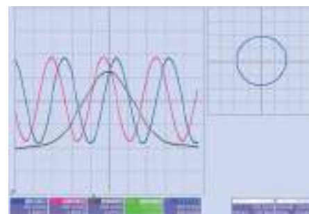
Segnali sinusoidali in uscita dal sensore. Sine-wave output signals from the sensor.
