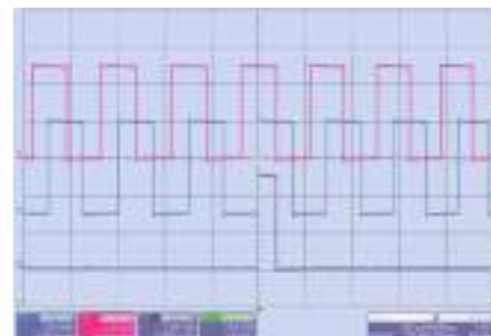
PBS-HR T: segnali ad onda quadra in uscita dal trasduttore. PBS-HR T: square-wave output signals from the transducer.
